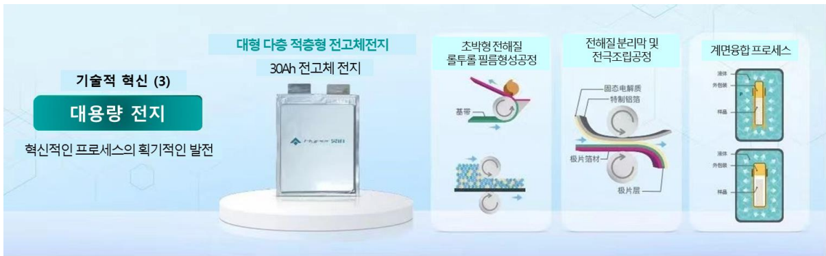
최대 30Ah의 용량을 가진 대형 다층 적층 전고체 전지 셀을 생산 가능
