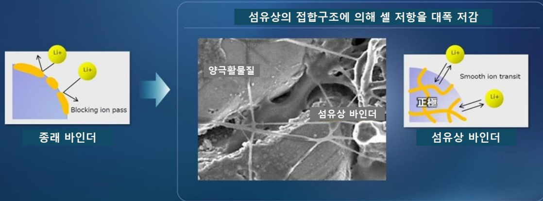
그림 5. 섬유상 바인더로 입자를 엮는다. Li 이온의 전도를 방해하지 않도록 배려했다. (출처: 닛산 자동차)
