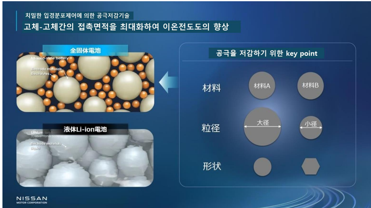
그림 4. 양극 활물질과 고체 전해질의 각 입자의 틈을 줄여 양자를 밀착시킬 필요가 있다. 왼쪽 상단의 이미지에서는 흰색이 활물질, 오렌지색이 고체 전해질. (출처: 닛산 자동차)
