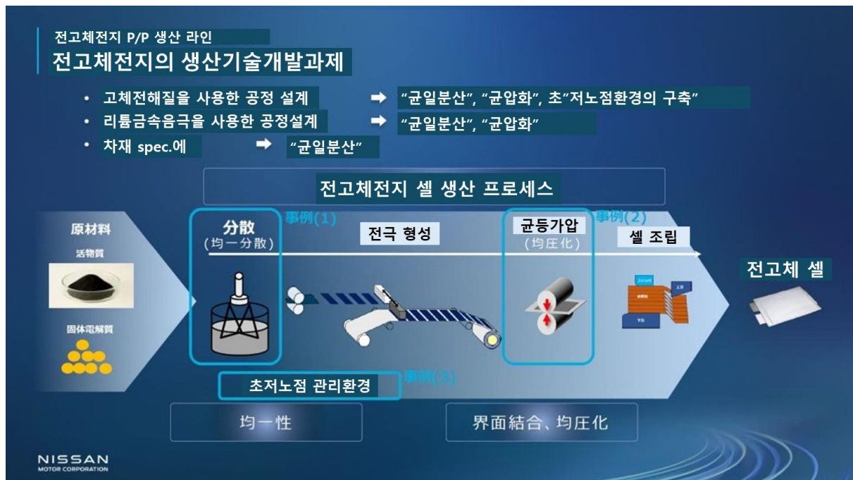
그림 6. 전극의 균일화를 목표로 한 생산 기술면에서의 대처. 슬러리에 있어서의 재료 입자의 균일 분산과, 도포한 막을 평활화하는 균등 가압의 기술을 개발하고 있다. (출처: 닛산 자동차)
